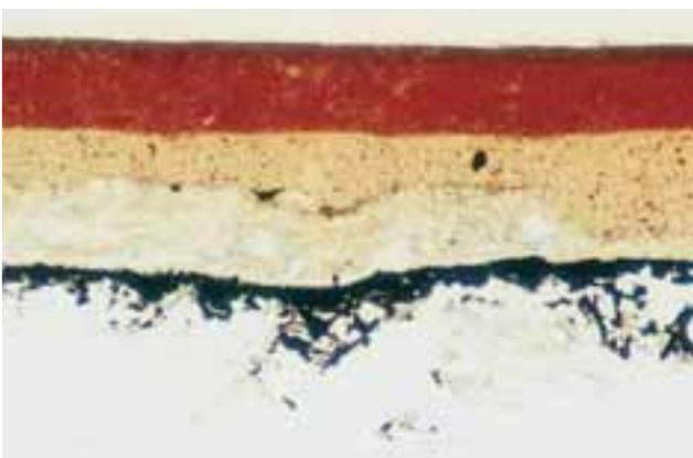
57 (834) 外面 (剥離箇所の接着部分) の断面 (×300)
