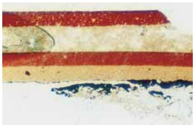
57 (834) 外面 (補修箇所の塗り重ね部分) の断面 (×300)
