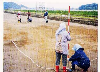
検出された遺構の輪郭にしたがって平板 へいはん （測量器）で略測図を作ります。
