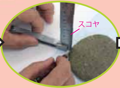
スコヤと鉛筆を使って平面の輪郭を写していきます。
