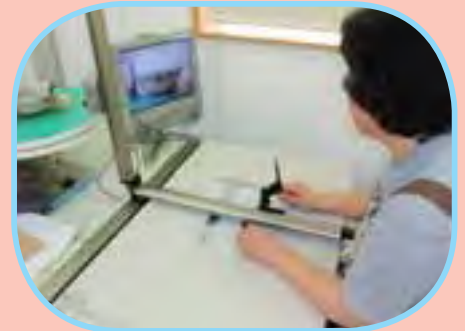
小型カメラの付いた実測器を使って形取りしているところです。
