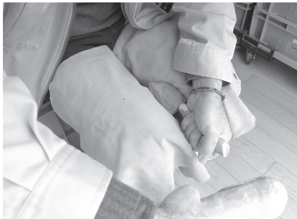
図26 作業面を上に向けて保持した際のテクニック (設置したパンチの角度や、打面の状況などが確認できない。 また、腕を前に出しておもに手首の回転でハンマーを振るジェ スチャーは、力強く打撃することが難しい：筆者撮影)
