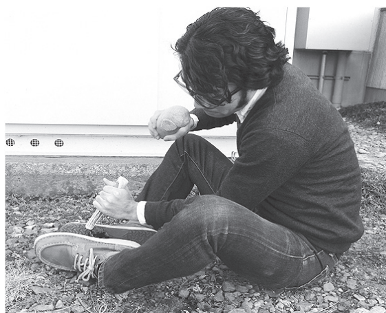
図 20 両足裏での保持 (目から打面が遠いため、パンチ先端や打面状況などの確認ができない。また、ハンマーを前に押し出すジェスチャーは、身体的に実施しにくい：大場 2008 [筆者撮影])
