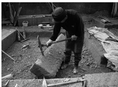
写真 84 身体動作・ツル削り（カオ加工）-1
