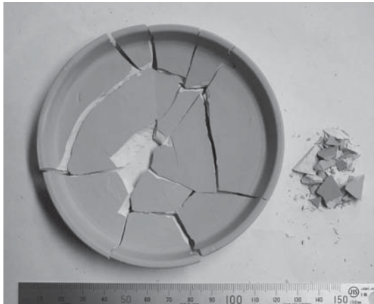
図10 カシ製棒状ハンマーで打撃した皿 (右は打撃部直下の砕片：床に置いて裏面を打撃)
