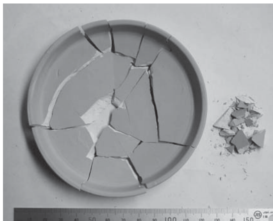
図10 カシ製棒状ハンマーで打撃した皿 (右は打撃部直下の碎片：床に置いて裏面を打撃)
