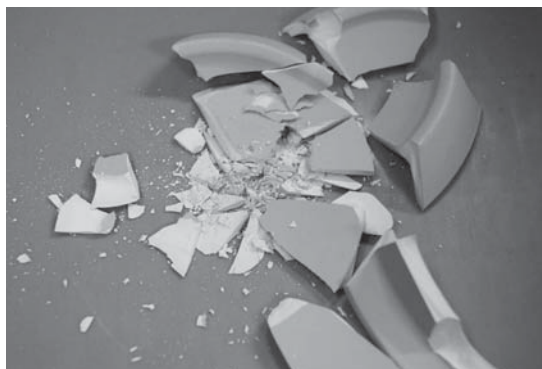
図11 硬石製ハンマーで打撃した皿を打撃した直後 (床に置いて裏面を打撃)
