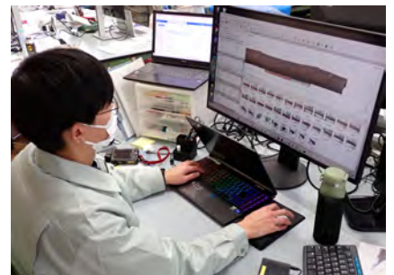
土橋部材の3次元写真計測
